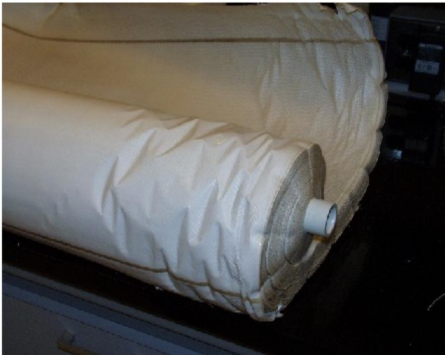
Figura 37 Membrana de OR danificada pela falta de limpeza adequada
