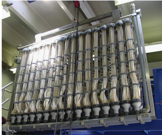
Figura 28 Esquema de um rack de membrana - Memcor®
