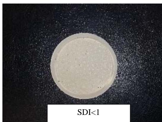
Figura 62 Membrana usada no teste SDI<sub>15</sub> após teste com permeado da UF - CLE
