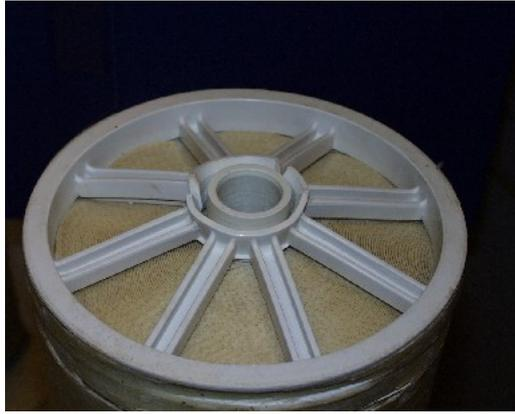
Figura 38 Modulo de OR danificado devido longo tempo em operação sem limpeza
