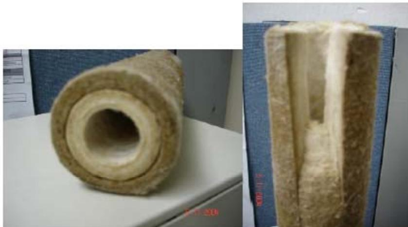
Figura 65 Filtro de cartucho após sete dias em operação – Site 2
