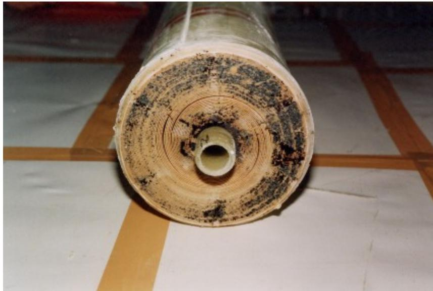
Figura 36 Módulo de OR entupido com biofouling
