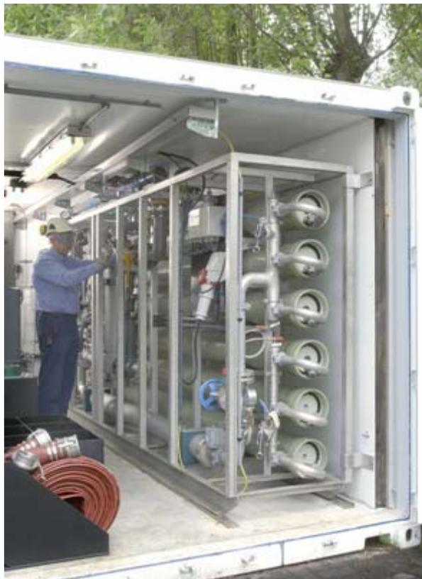
Figura 34 Módulo móvel de OR em espiral (Anjou Recherche, 2004)
