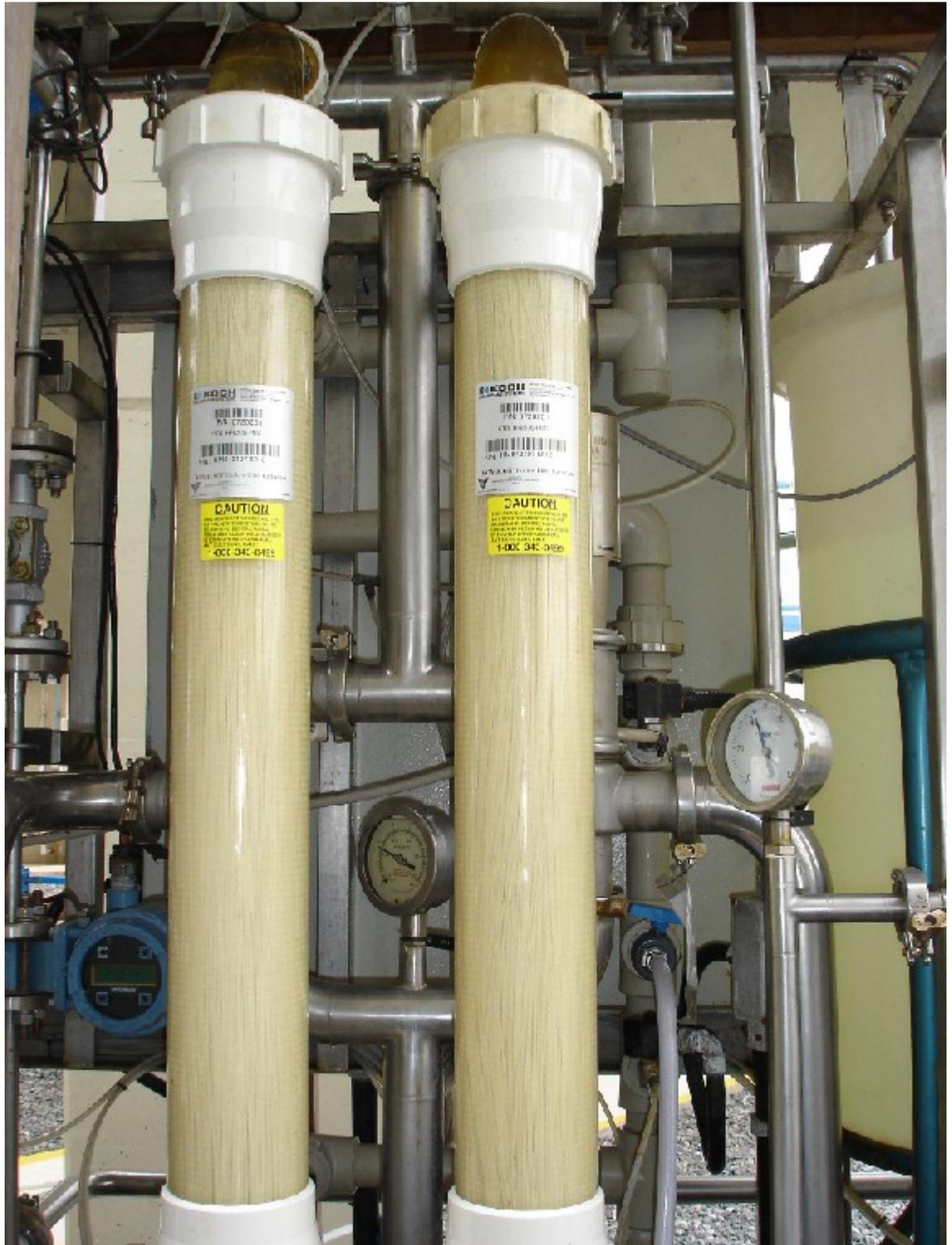
Figura 42 Cartuchos de UF instalados na planta piloto
